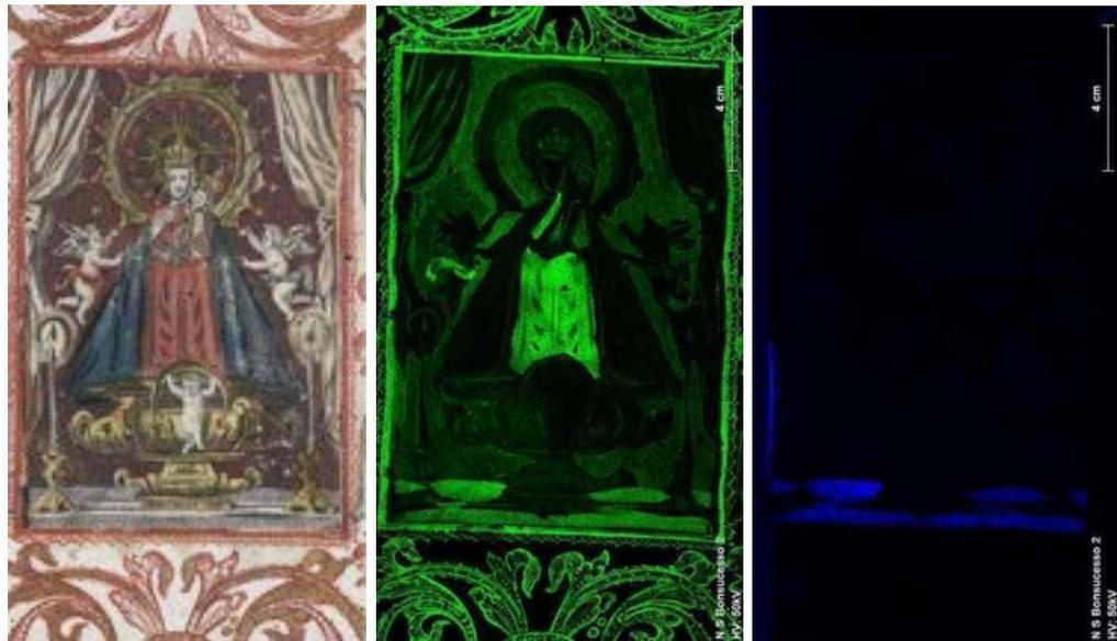
**Figura 14.** Detecção de sulfeto de arsênio na mesa que sustenta a figura da Virgem. A presença de enxofre nas demais áreas ornamentais está associada ao pigmento vermelhão (sulfeto de mercúrio). Fonte: Instituto de Criminalística da Polícia Federal, 2024.
