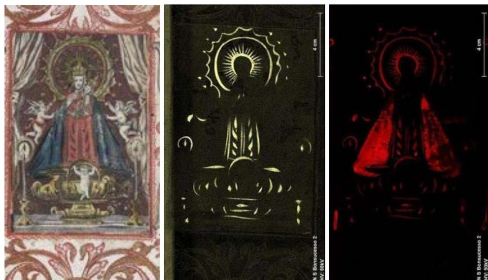
**Figura 12.** Mapeamento de latão (liga de cobre e zinco) no resplendor de Nossa Senhora e em detalhes ao redor. A presença de cobre no manto está relacionada ao pigmento azul verdetera (carbonato básico de cobre). Fonte: Instituto de Criminalística da Polícia Federal, 2024.
